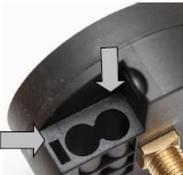
Das Batteriefach öffnen, die alten Batterien entfernen und durch neue ersetzen. (Auf korrekte Polarität achten!) Im Anschluss das Batteriefach wieder schließen, den Gummischutz wieder überstülpen und den Füllschlauch anbringen.
